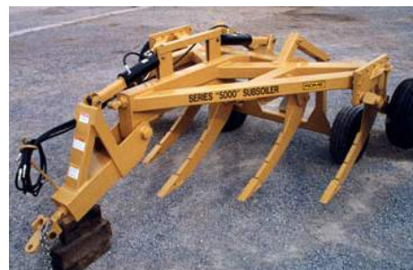
Subsoladores y desgarradores
