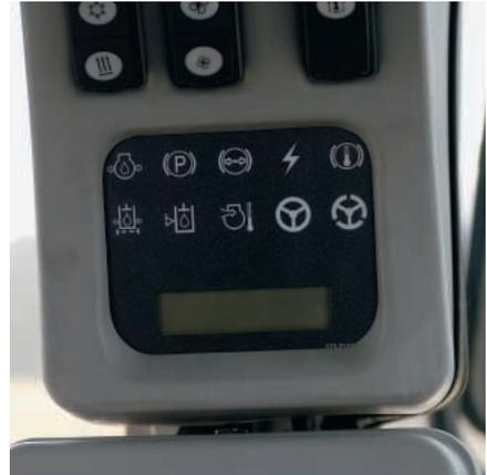
**Sistema Monitor Caterpillar.** El 950H está equipado con el Sistema Monitor Cat (CMS) que vigila el estado de su cargador. El CMS supervisa las funciones críticas del motor y disminuirá la potencia del motor para protegerlo contra los daños si es necesario. Dependiendo de cuál de las seis condiciones siguientes surja, el monitor del CMS o el tablero delantero mostrarán luces de advertencia y alarmas audibles.
