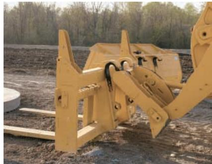
**Acoplamientos rápidos.** Los acoplamientos rápidos proporcionan una versatilidad sin igual. El modelo hidráulico permite a un operador cambiar accesorios en segundos sin salir de la cabina. En el modelo manual, el operador debe trabar los pasadores.
