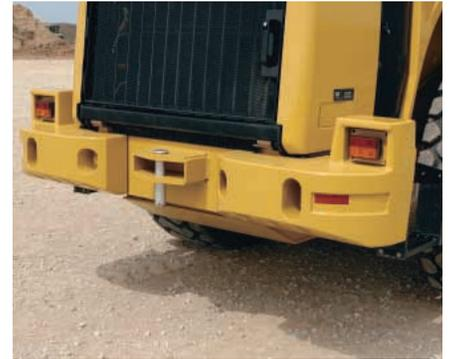
**Contrapeso.** El contrapeso de dos piezas está integrado en el diseño y estilo del 950H. Este contrapeso de 1.853 lb (840 kg) incorpora las luces traseras en la parte superior de la estructura.
