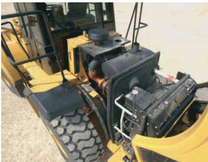
**ACCESO DEL COMPARTIMIENTO DEL MOTOR.** El capó no metálico del 950H se ha cambiado de diseño y estilo con respecto a modelos previos. Los paneles laterales y superior son más fuertes debido a unas nervaduras de refuerzo más robustas – el cambio de contorno también aumenta la rigidez del capó.
