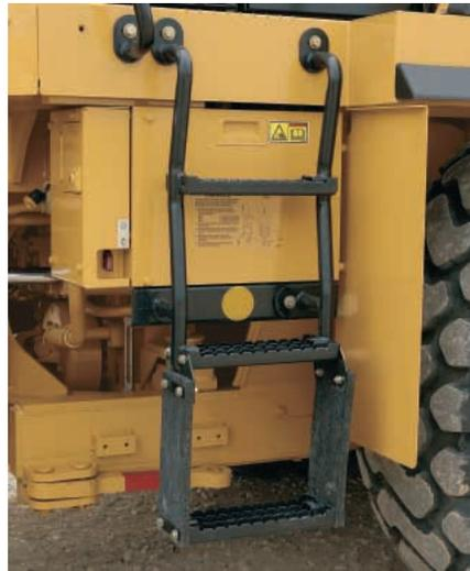
**ENTRADA Y SALIDA.** La presencia de una escalerilla con escalones de limpieza automática reducen al mínimo la acumulación de residuos. La escalerilla está inclinada 5° hacia adelante para facilitar la entrada y la salida.
