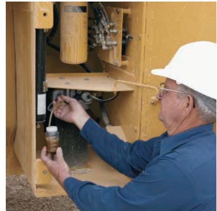
**SERVICIOS S•O•S.** Las válvulas de muestreo del 950H permiten un acceso rápido a los aceites del motor, transmisión e hidráulico para su análisis S•O•S. Los intervalos de cambio de aceite y otros servicios pueden optimizarse según su programa de trabajo, reduciendo el tiempo de inactividad y los gastos de administración.
