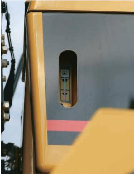
**MIRILLAS.** Mirillas bien protegidas pero fácilmente visibles para el aceite de la transmisión e hidráulico y el refrigerante del radiador que permiten comprobaciones diarias sencillas a la vez que reducen el riesgo de entrada de contaminantes en el sistema.
