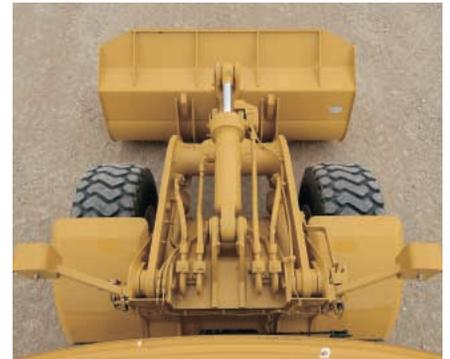
**Varillaje.** El varillaje del 950H tiene un diseño de barra en Z de una sola inclinación horizontal. El varillaje de la barra en Z genera una fuerza de desprendimiento excelente y tiene un buen ángulo de inclinación hacia atrás para cargar mejor el cucharón y retener mejor la carga.
