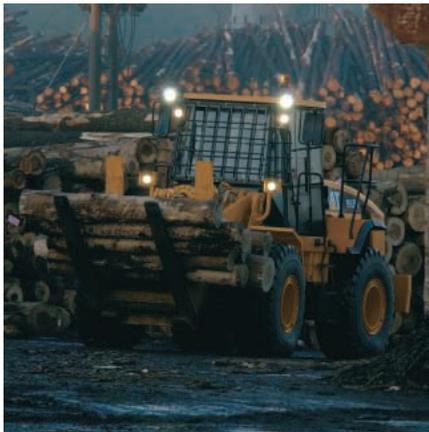
**Aplicaciones forestales.** La configuración de máquina forestal proporciona un control de amortiguación, un cilindro de inclinación horizontal de servicio pesado y un contrapeso adicional para usar en aplicaciones forestales y madereras. Las herramientas especialmente diseñadas para aplicaciones forestales pueden instalarse en fábrica.
