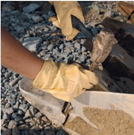
**Herramientas de corte.** Se dispone de varias opciones de herramientas de corte de Caterpillar para los cucharones del 950H. Se ha incorporado al diseño de los cucharones un adaptador de esquinas de fundición que permite colocar un diente en la esquina del extremo para protegerlo contra el desgaste del cucharón de base.
