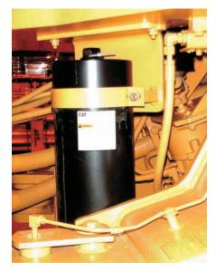
Control de Amortiguación. El Sistema de Control de Amortiguación mejora la amortiguación, el rendimiento y la retención de carga al desplazarse por terrenos accidentados. Los operadores toman confianza al desplazarse a mayores velocidades en las operaciones de carga y acarreo disminuyendo los ciclos y aumentando la productividad.
