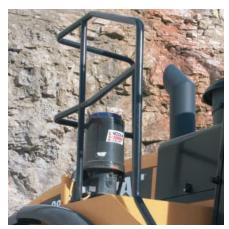
Lubricación automática. La función de Autolubricación, disponible ahora como una opción instalada en fábrica, proporciona una lubricación automática y precisa de los pasadores y bujes durante la operación de la máquina. La lubricación de la máquina durante su funcionamiento reduce el tiempo de inactividad planificado, el mantenimiento diario y las reparaciones costosas.
