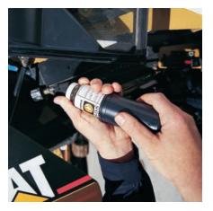
Muestreo de fluido S•0•S. Las válvulas de muestreo de aceite permiten un acceso rápido al motor, a la transmisión y a los aceites hidráulicos para el análisis de S•O•S. Los orificios de muestreo para la dirección, la transmisión y los frenos están agrupados en compartimientos de servicio trabables detrás de la cabina. El programa S•O•S permite detectar problemas antes de que ocurran y facilita una programación más conveniente del servicio.
