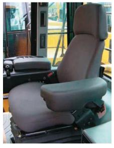
Asientos. El asiento Comfort de la Serie C-500 de Cat es fuerte y duradero y se puede ajustar en 6 direcciones para acomodar a operadores de todos los tamaños. El respaldo y el asiento de una sola pieza de fundición impiden protuberancias debajo de los cojines. El asiento tiene un soporte lumbar estilo automotriz para máxima comodidad. El posabrazos derecho con controles integrados del accesorio se ajusta para permitir una operación cómoda y confortable.
