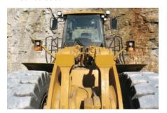
Estructuras. El 980H conserva las mismas estructuras básicas que el 980G de la Serie II. Bastidor de extremo de motor de sección en caja que absorbe las cargas de impacto y las fuerzas de torsión mientras soporta la línea de impulsión para lograr el alineamiento de los componentes rígidos. El 90% del bastidor está soldado por medio de robots proporcionando una penetración profunda de la soldadura para lograr una durabilidad y una resistencia a la fatiga máximas.
