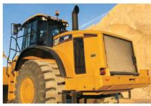
Capó nuevo. Se ha diseñado un capó nuevo para el 980H. El nuevo capó, de dos capas de espesor, tiene una mayor durabilidad a la vez que mantiene la visibilidad del terreno. El capó reforzado es más resistente al viento y a la acumulación de barro. También se ha mejorado el sistema de accionamiento. Dispone de cilindros de levantamiento dobles activados electrohidráulicamente que reducen considerablemente el tiempo de subida y bajada.
