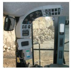
**Controles.** El tablero de control principal del 980H está ubicado en la parte alta del poste derecho de la estructura ROPS – permitiendo que el operador tenga todo al alcance y manteniendo la visibilidad del terreno. La presencia de símbolos gráficos claros hace que los interruptores sean fáciles de entender y operar.
