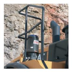
Autolubricación. El sistema de Autolubricación optativo proporciona una lubricación automática precisa de los pasadores y los bujes durante la operación del 980H. La lubricación automática reduce el tiempo pasado en tareas diarias de mantenimiento y el tiempo de inactividad para reparaciones no planificadas debido a un engrase insuficiente – dejando más tiempo cada día para ser productivos.
